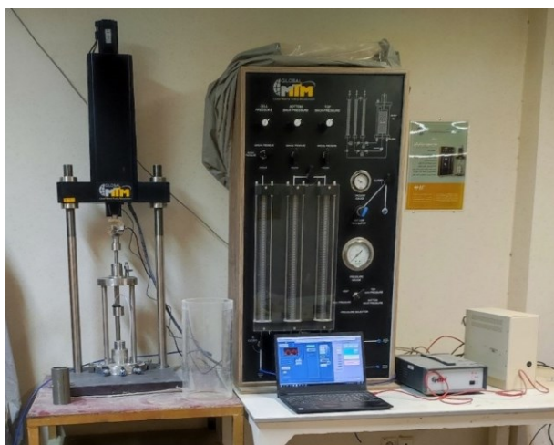
شکل ۳. دستگاه ۳ محوری سیکلیک مورد استفاده در این پژوهش
